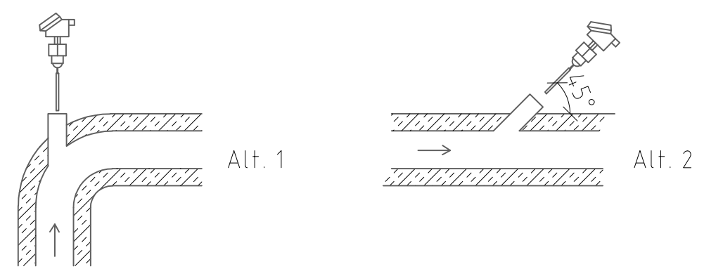
Montage av temperaturgivare
